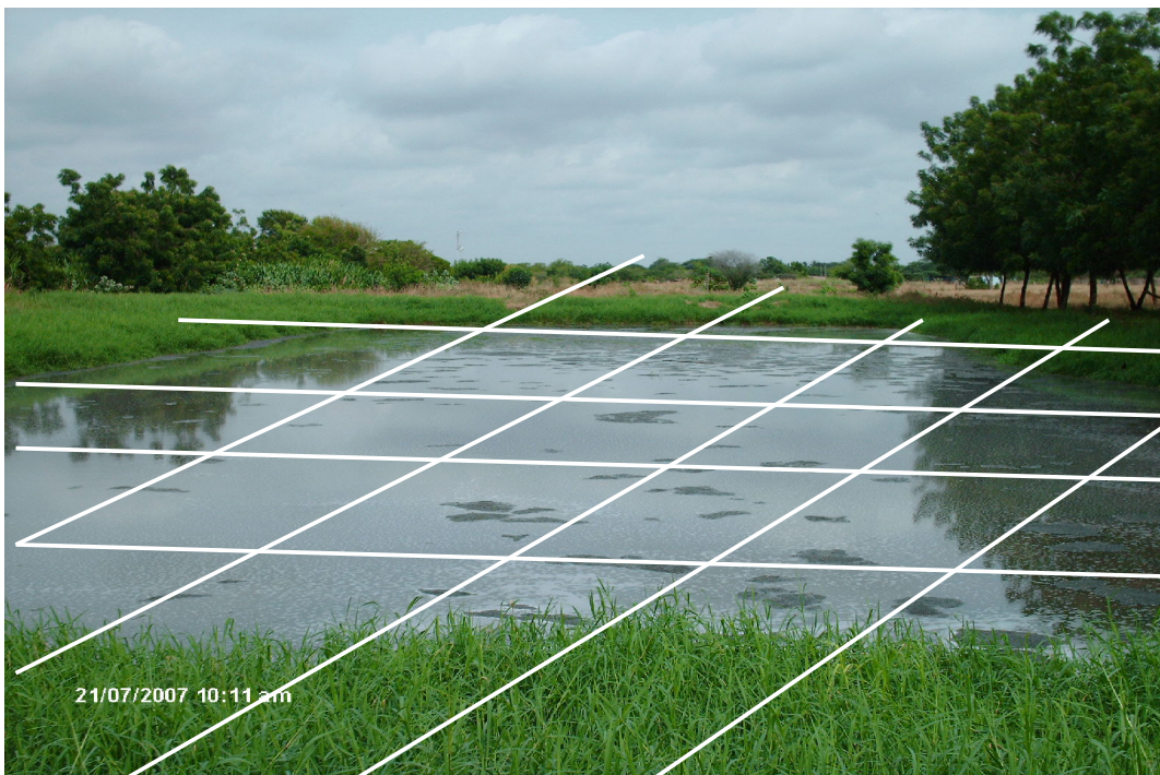
Figura 2. Vista de las cuadrículas imaginarias de 3 m x 3 m en la segunda laguna
