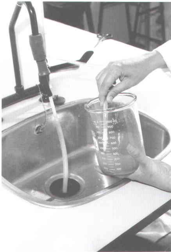
Fig. 2. Élimination du surnageant avec une pompe aspirante.
