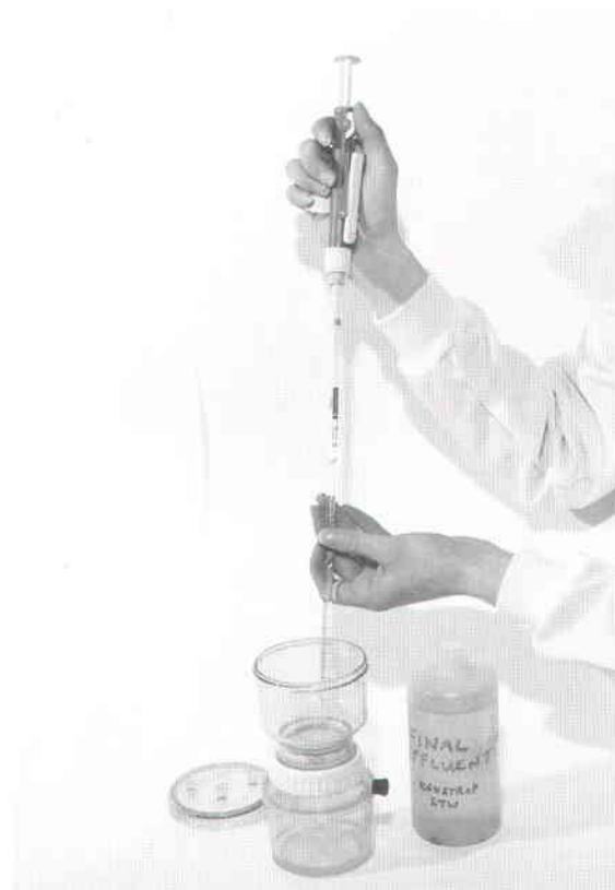
Fig. 20. Addition de 5 ml d'échantillon dans l'unité de filtration sur membrane.
