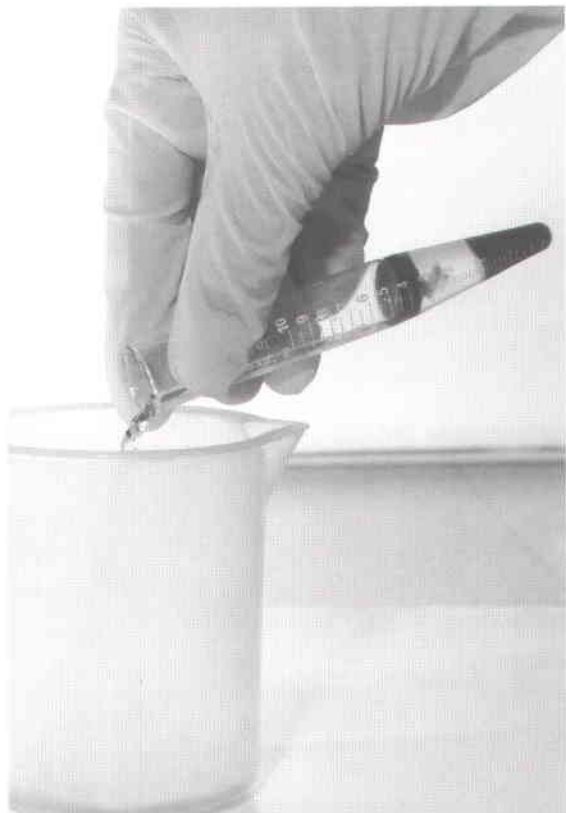
Fig. 7. Après rejet du surnageant, seul subsiste le culot de centrifugation.
