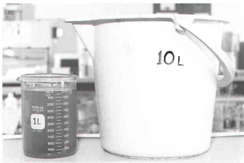
Fig. 1. Récipients cylindriques particulièrement adaptés à la sédimentation.
