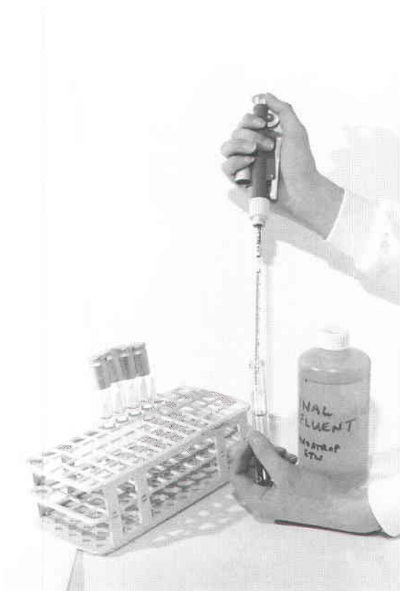
Fig. 13. Addition de 1 ml d'échantillon à 9 ml de diluant, de façon à obtenir une dilution au dixième (1:10).
