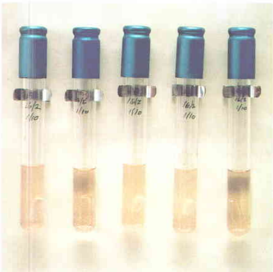
Fig. 15. Après incubation à 44° C pendant 24 h, on observe la production de gaz dans trois des tubes. On voit au Tableau 2 que le NPP est de 910 coliformes fécaux par 100 ml d'échantillon (d'eaux résiduaires traitées).
